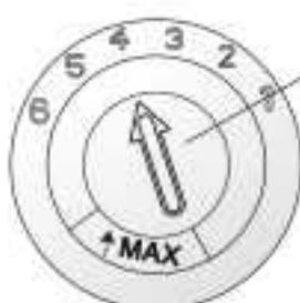
El depósito de líquido de aclarado tiene 6 ó 4 posiciones. Comience siempre con la posición 2. Si aparecen demasiadas gotas tras el aclarado, o el secado de los cubiertos es imperfecto, quite la tapa del depósito y aumente la cantidad de líquido y coloque el mando en la posición 5. Si los platos aún no se secan adecuadamente, ajuste el regulador a una posición más elevada hasta que el aclarado y secado sean perfectos. Le aconsejamos situarlo en la posición 4 (de fábrica).
